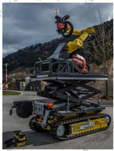
NLINK (Норвегия) отвечает за поставку роботизированной руки и сенсорной технологии для строительной отрасли. Ее оборудование способно планировать и выкапывать участки, устанавливать столбы или иловые ограждения и даже заливать бетон.
