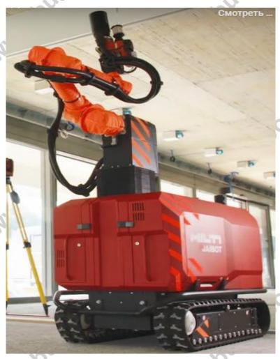
Jaibot — это полуавтономный мобильный буровой робот для анкерных отверстий, который выполняет задачи на основе цифровых данных планирования.
