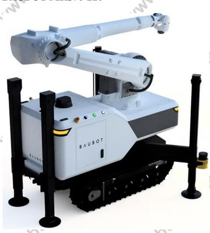
Роботы Baubot MRS обладают широкой функциональностью. Прежде всего, они могут выступать в качестве "третьей руки", помогая в операциях, где нужно что-то подержать. Точность позиционирования - до 1 мм. Например, робот может держать привариваемый к основе фрагмент. Впрочем, робот способен вести сварку и самостоятельно.
