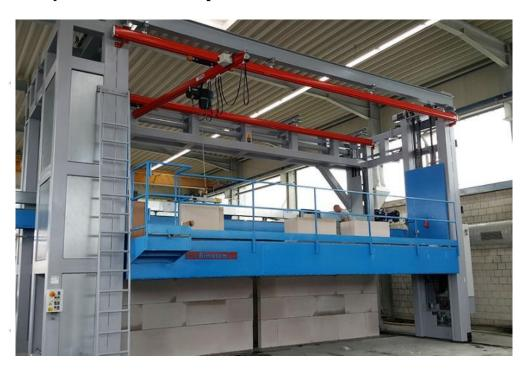
Полуавтоматический робот для каменной кладки НА4 может использовать обычный раствор или новые клеи, справляется с рабочей шириной до 13 метров и высотой стен до 4 метров.
