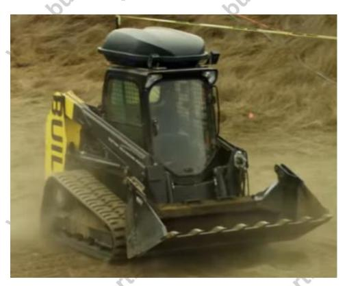
Самоуправляемый робот-экскаватор разработан на основе минипогрузчика компании Bobcat. В него установили камеру, лидар, GPS-приемник, модуль беспроводной связи и другие устройства. По утверждению разработчиков, установленный в экскаватор лидар отличается от используемых в беспилотных автомобилях тем, что рассчитан на гораздо большие вибрации и удары, что важно для строительной техники.
