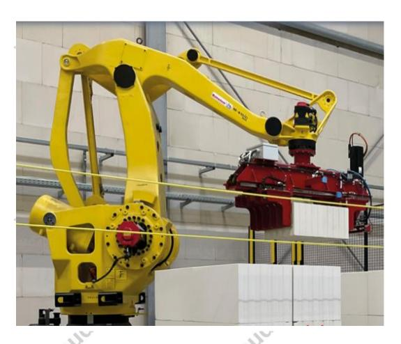
Роботизированная машина для каменной кладки RA1 — модульное решение для полной автоматизации. Его можно комбинировать по желанию с другими типами машин, в частности с HA4.
