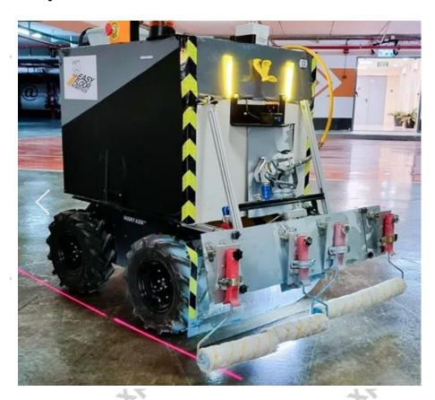
Мобильный робот для быстрого и точного автоматизированного формирования бесшовных напольных покрытий. Используется для устройства полов в складских и промышленных комплексах, гаражах, на заправках и в подземных паркингах.
