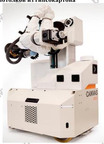
1200СХ — компактная машина для распыления и шлифования с самым большим вылетом в мире. Ее способность к самостоятельному управлению и управлению всеми колесами позволяет легко выполнять автоматическое позиционирование и маневрирование в ограниченном пространстве.
