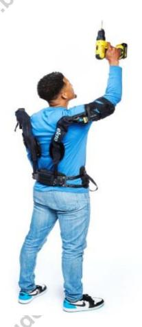
EksoWorks (США) разрабатывает промышленные экзоскелеты для обеспечения повышенной поддержки рабочих, выполняющих ручные задачи, такие как подъем или сверление. Эта технология помогает рабочим поддерживать полный диапазон движений, минимизируя при этом физическое напряжение, что приводит к меньшему количеству травм, повышению эффективности и снижению компенсаций работникам.
